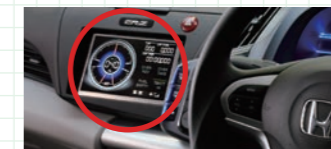
●エコアシストメーター ※Lapあたりの燃費とタイム、充電量、回生量、燃料消費量などを表示できる多機能専用メーター。
